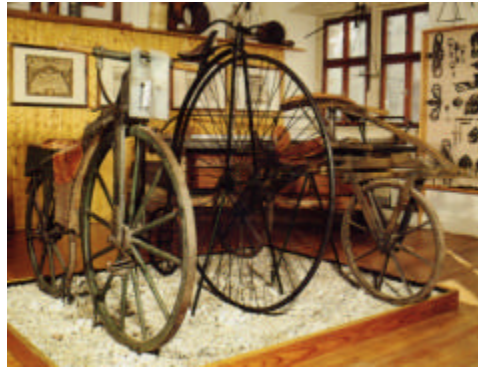
v. li.: Fischers Tretkurbelfahrrad, Hochrad, Draisine in den Städtischen Sammlungen Schweinfurt: Foto Keetz
