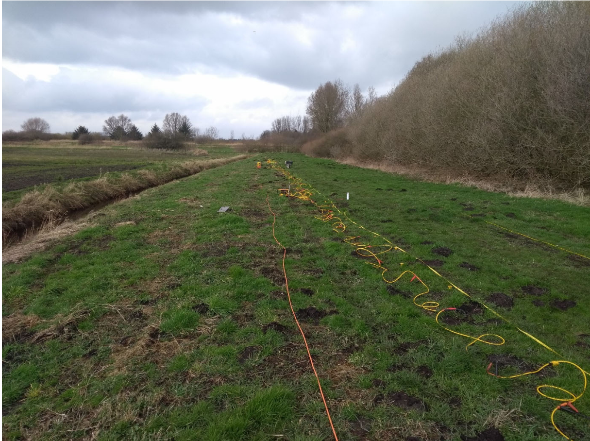
Abbildung 2: Eine Messlinie mit den Sensoren in regelmäßigem Abstand. Die Länge der Messlinie variiert in Abhängigkeit der Anforderungen an die Messung
