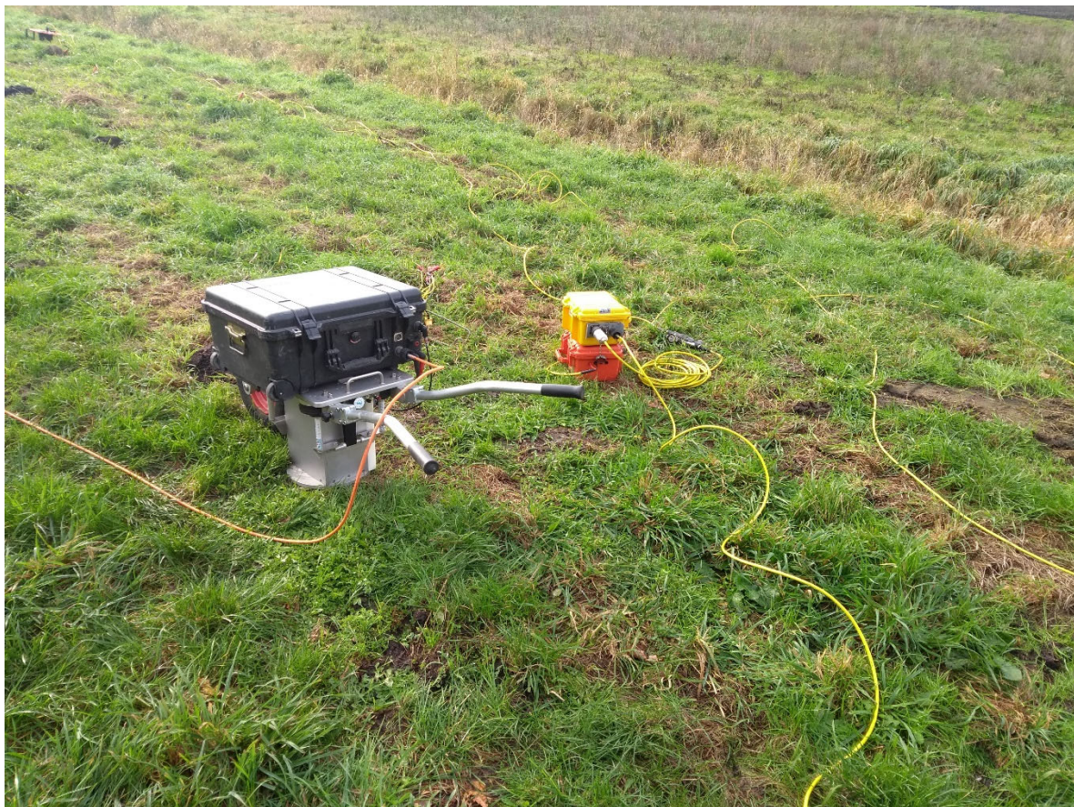
Abbildung 1: Die seismische Vibratorquelle ELVIS VII. Die Quelle ist so groß wie eine Schubkarre und wird von einer Person bedient.
